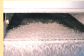
③ 撰穀板上に残っているコメ(石等の夾雑物は含まれていない)を良米側に自動的に排出する
